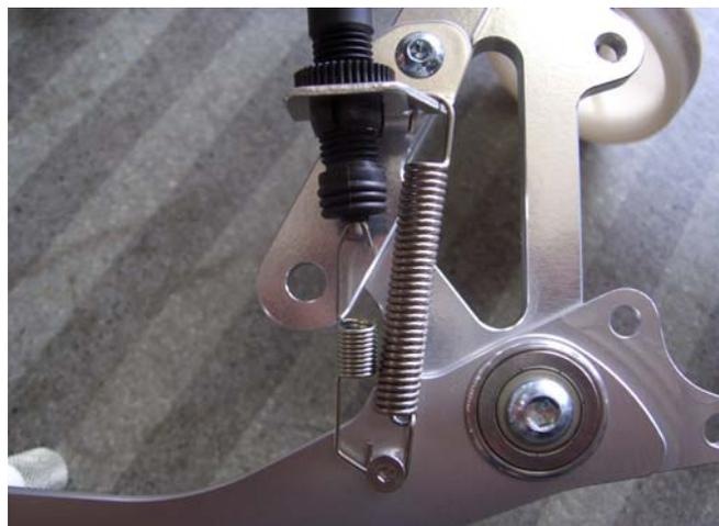
図のようにブレーキロッドを取り付けます。ジュラコンカラーを調整してペダルの高さを調整してください。
