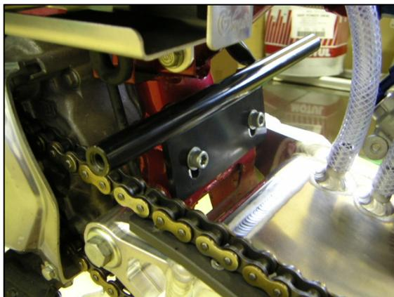
3. 矢印のエンジンマウントのボルトをはずし G のシャフトに代えてください
