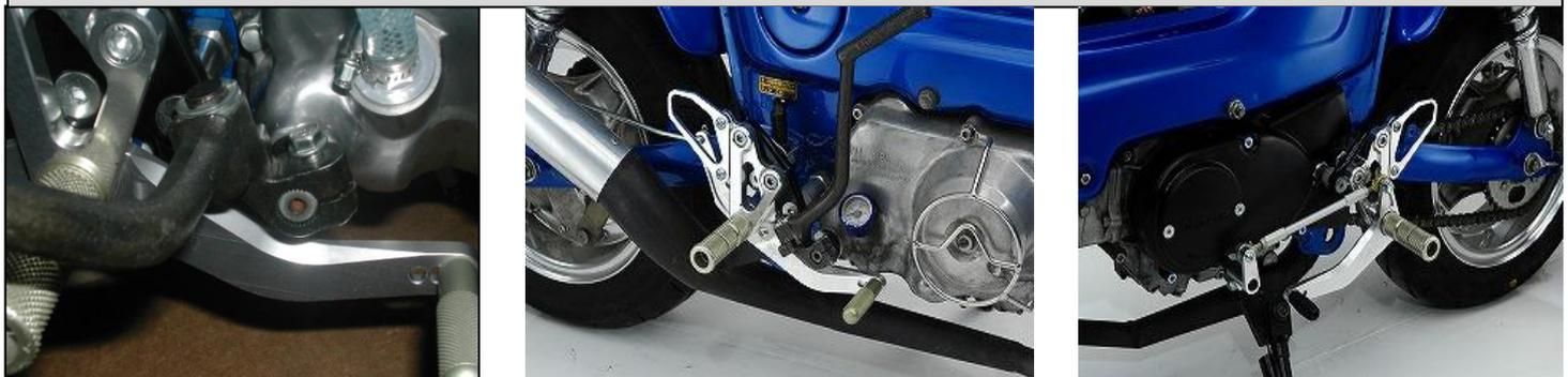
13、キックアームは、モンキーR 純正か、社外品のオフセットタイプ(キタコ製推奨)に交換してください。(ボルト固定時には、ステップとの干渉を防ぐためキックペダルを手前に引きながら締めて下さい。)
