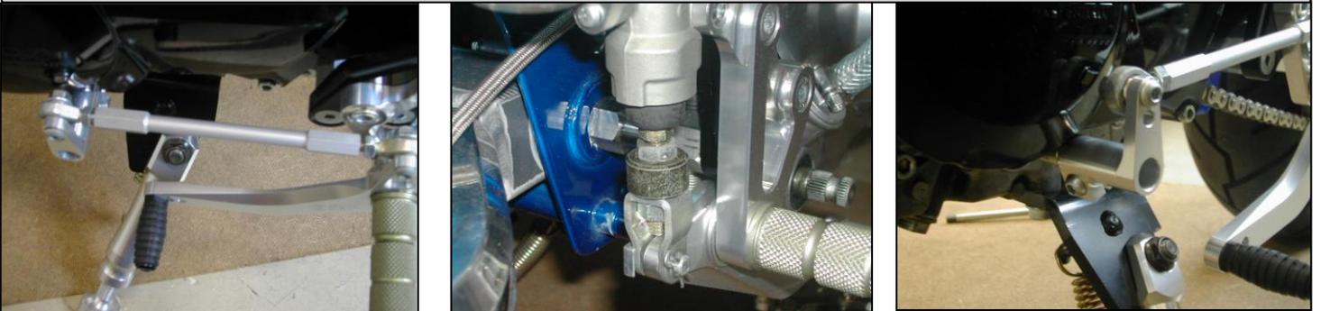
10、チェンジ側にシフトリンクを取り付けます。シフトリンクの向きは画像を参考にしてください。
