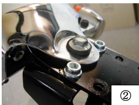
上側ステーと、メインステーをM6 フランジボルトとナットで固定します。お好みの位置に取り付けてください。(画像①)
