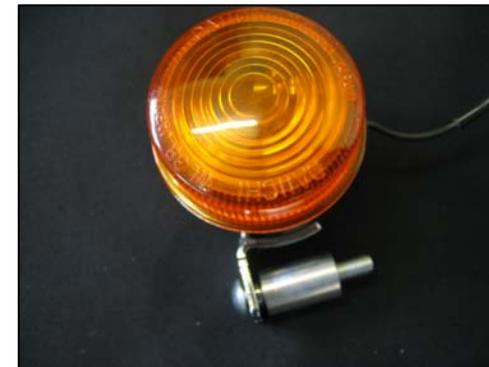
5L用のウインカーにM6×35mm ボタンボルトを奥まで差し込みます。
