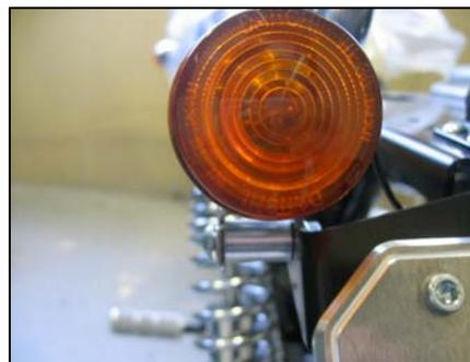
上記で用意したウインカーをメインステーに固定します。ステー裏側からM6 フランジ付きナットで固定します。左右同じように固定してください。
