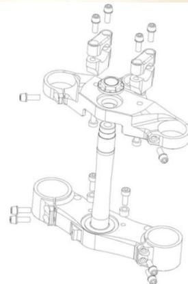
①サービスマニュアルを参考に純正トップブリッジ、アンダーブラケット、キーシリンダーを外します。
