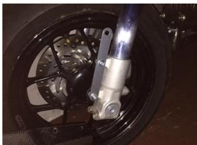
⑦フェンダーステー(3113411)を純正ボルトを使用し、フォークと固定します。フェンダーステーとフェンダーを固定します。真ん中の穴は純正ボルトでフォークと共締めし、上の長穴を付属のボルト(65018)とロックナット(65279)で固定します。
