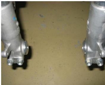
④フォークに専用カラーLR(611525、611526)を差し込みます。ブレーキ側にタップ無しのRカラー、反対側にタップ有りのLカラーをフォークの内側から差し込みます。
