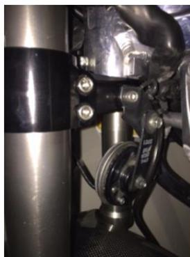
⑨ホーンをアンダーブラケット後方の取り付け穴に左図のように位置を調整して取り付けます。
