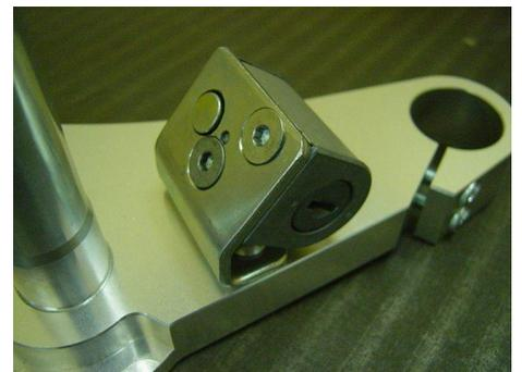
5. アンダーブラケット部を車輛に組みつけていきます。組みつけ前に、ステアリングベアリング等を一度洗浄し、グリスアップしておいてください。車輛への組みつけに関しては純正と同じです。サービスマニュアルを参照してください。
