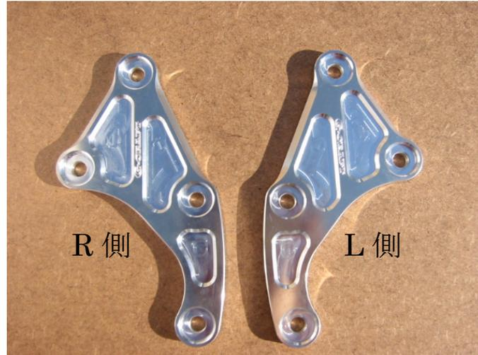
2. アルミプレート L側から純正ボルト4本を差込み車体に取り付けます。
