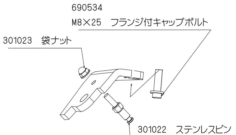
**各部ボルトの締め付け確認と各部品の干渉が無いかを確認して作業終了です。**
