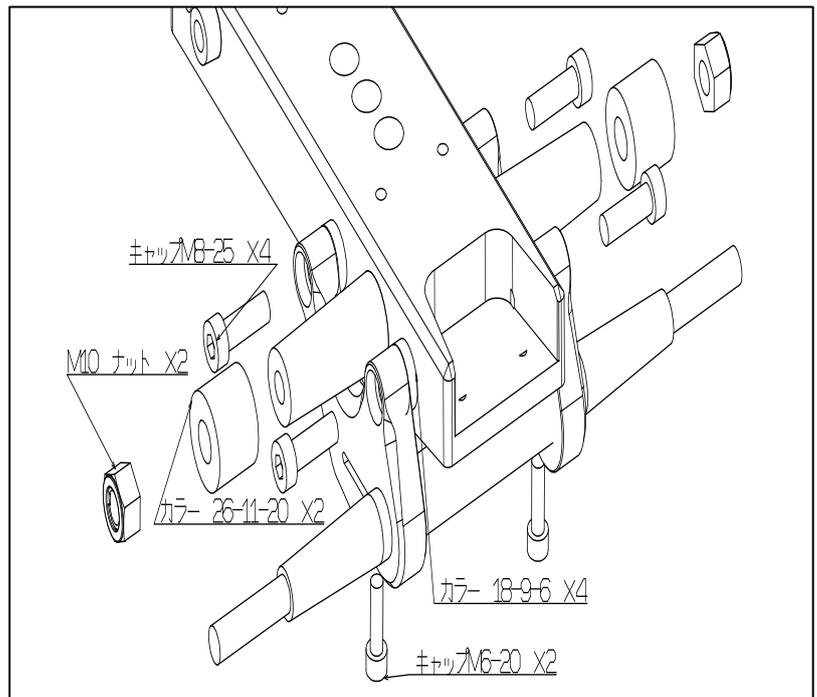
○フレームとの間に厚み 6mm のカラーを挟んで、付属の M8-25 のボルトでプレートを取り付けてください。
