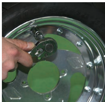
リアホイールを組み立てます。ホイールのボルトは対角線上に締めていきましょね
