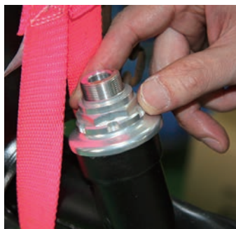
トップスレッドを取り付けます。トップスレッドもGクラフトならではの削り出し品です
