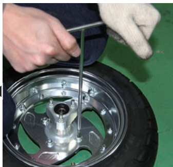
ディスクハブを取り付けていきます。傷をつけないように細心の注意を払いましょう
