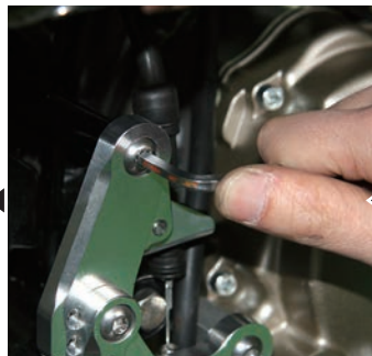
装着されていたOVER製のバックステップを取り外します。2本留めですね
