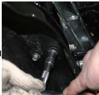
ロングスイングアームに変更するとタイヤが当たってしまうので、リアフェンダーを外しておきます
