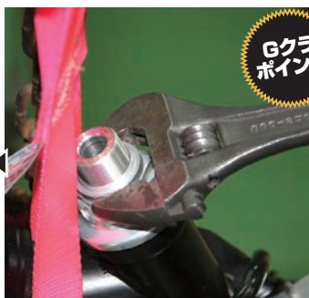
トップスレッドが作業しやすいようにナット型になっているのも、Gクラフトならではの仕上がり
