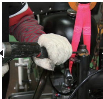
トップスレッドを外します。専用工具がない場合は写真のようにマイナスドライバーが使えます
