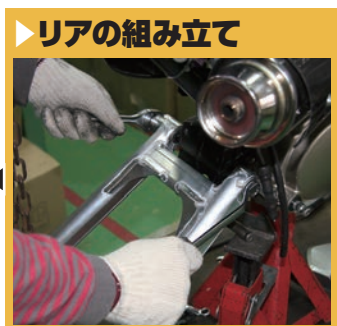
まずはスイングアームを取り付けます。ピボットシャフトにグリスを塗るのを忘れずに
