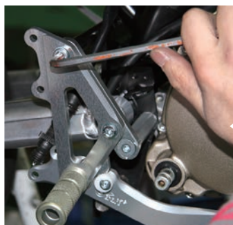
チェンジ側のステップも取り付けます。左右取り付けたら位置決めをして本締めします
