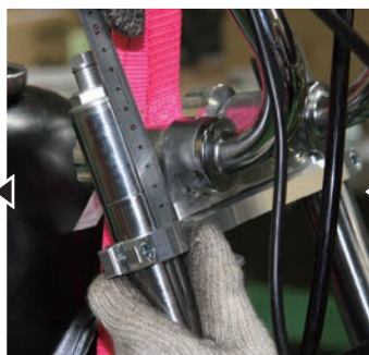
10cmロングスイングアームを想定してフォークの突き出しを調整します
