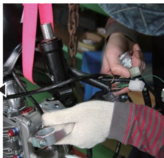
車体側にステムを取り付けます。落ちない程度にトップスレッドを締め込んでおきましょう
