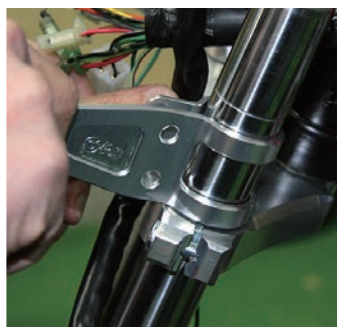
少し作業が前後しますが…(実は間違えました)ヘッドライトステーを取り付けます
