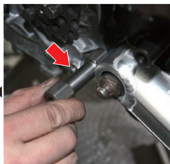
バックステップを取り付けます。矢印の部分が凹んでいるのはチェーンを避けるように工夫してあるんです
