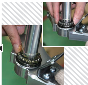
レース部にベアリングを取り付けます。ベアリング、シャフト部にはグリスを塗っておきましょう
