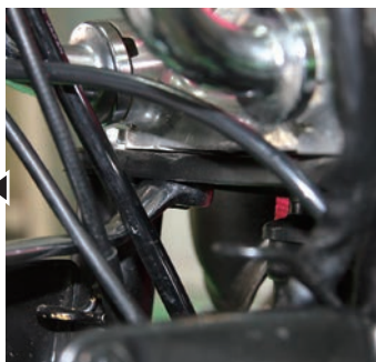
ステアリングハンドルホルダーを留めているトップブリッジ下の2つのボルトを緩めます
