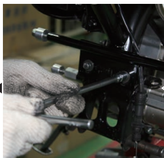
フレームに装着されていたバックステップのステーを外します
