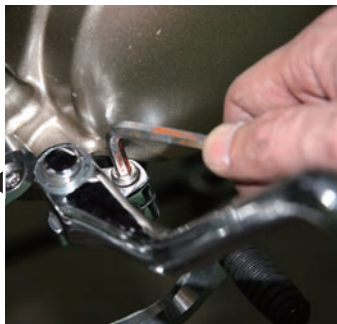
今回はディスクにするためバックステップを変更します。工具が入らないのでキックアームを外します
