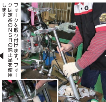
車体側にステムを取り付けます。落ちない程度にトップスレッドを締め込んでおきましょう
