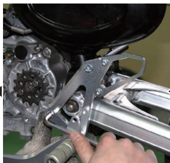
ブレーキ側のステップを取り付けます。まずは仮留めでOKです
