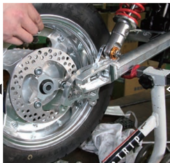
スイングアームにサポートを組み、リアディスクローターを付けたホイールを取り付けます
