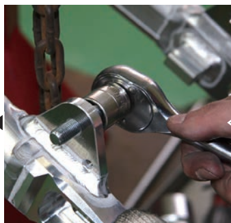
スイングアーム側のサス受け用のボルトを締め込んでいきます
