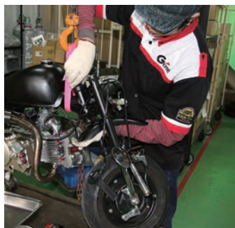
車体を安定させ、最後はトップスレッドを手で緩めながら、フォークを引き抜いていきます
