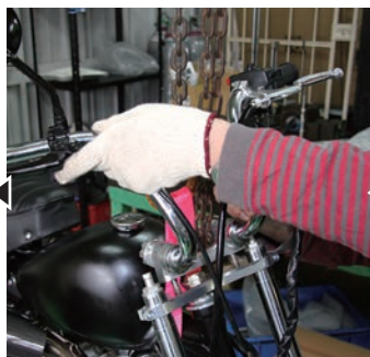
ステアリングハンドルホルダー(いわゆるハンドルですね)をトップブリッジに取り付けます
