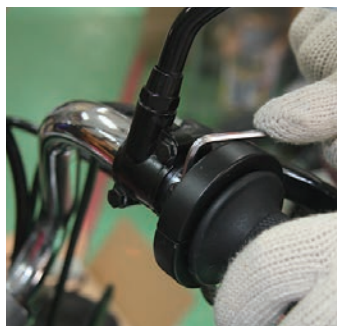
アクセルワイヤー類が邪魔なのでスロットルも外しておきます
