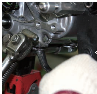
ノーマルステップを加工してその場しのぎで取り付けていた(笑)スタンドを外します
