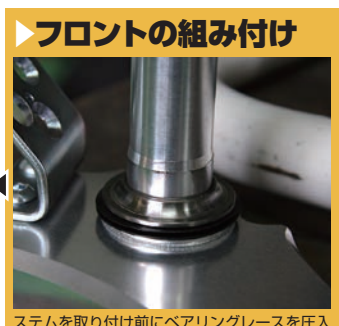
ステムを取り付け前にベアリングレースを圧入します。Gクラフトさんではステム注文時にオプション(¥2,205)で受付中
