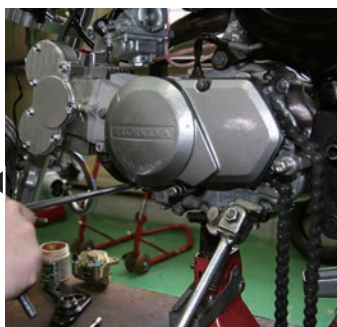
のちのちチェーンを交換することになるのでジェネレーターカバーも外しておきます
