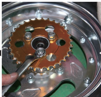
スプロケットを取り付けます。アルミホイールにゴールドが栄えます
