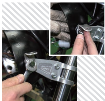
ライトステーにライトケース、ウインカーステーを共締めします
